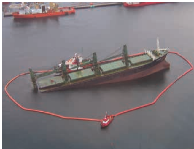
▲ Figura 12: barrera inflable anclada alrededor de los restos de un buque parcialmente hundido para contener cualquier posible fuga de combustibles líquidos.
