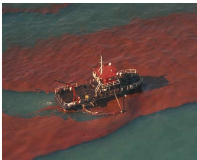
▲ Figura 10: sistema de recolección con una única embarcación que emplea una barrera de cortina corta desplegada desde un catamarán de recolección de hidrocarburos, en petróleo crudo muy emulsionado.
