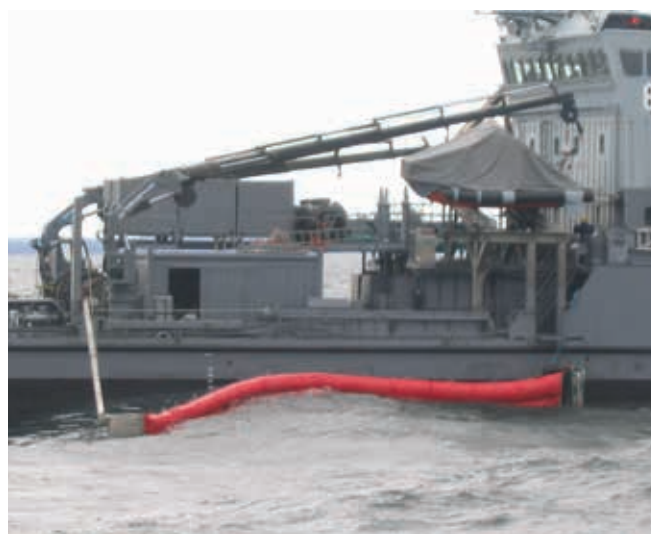
▲ Figura 11: aunque la barrera es suficientemente flexible para seguir el movimiento de las olas, se ha elevado del agua en el punto de fijación al casco; esto puede permitir el escape de hidrocarburos desde el vértice.
