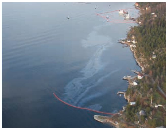
▲ Figura 14: barrera utilizada como un espolón para desviar hidrocarburos hacia la orilla para su recolección (© Norwegian Coastal Administration).
