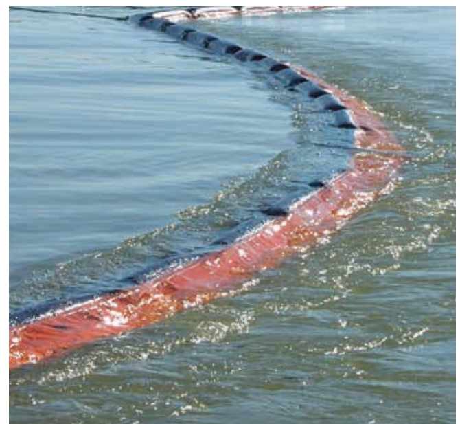
▲ Figura 4: la corriente fuerte ha provocado que la barrera pierda verticalidad, lo que permite el escape de hidrocarburos por debajo del faldón.
