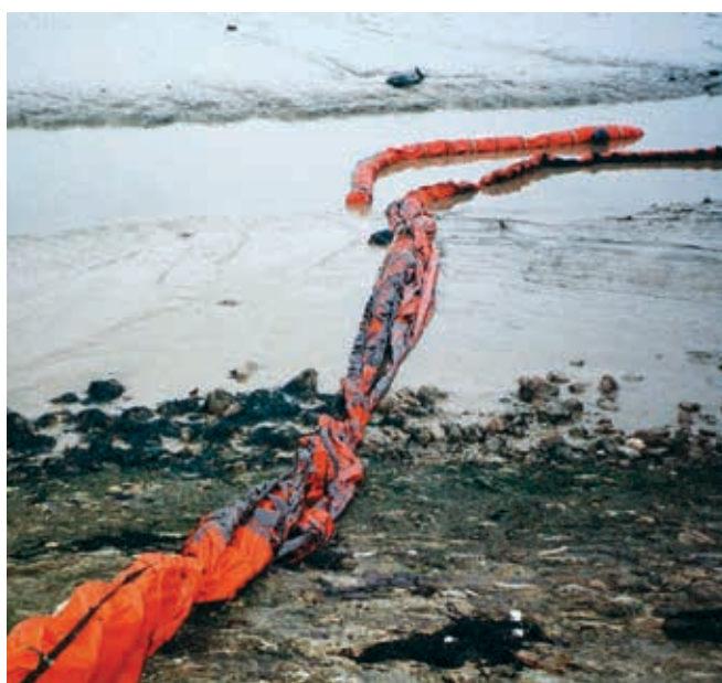
▲ Figura 5: una barrera puede dañarse con facilidad una vez desplegada. Se requiere prestar atención especial para asegurar que se mantenga su eficacia durante el ciclo de las mareas.
