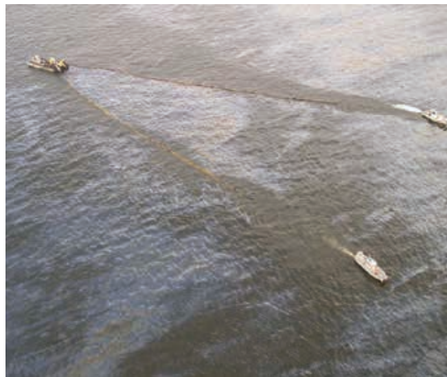
▲ Figura 9: uso de una barrera de cortina con una configuración en V mediante dos remolcadores con una embarcación de recolección independiente en el vértice.
