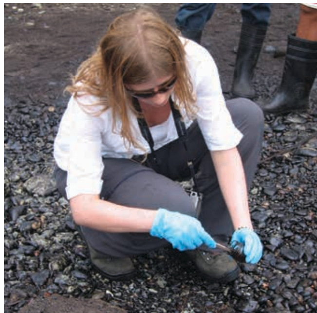
▲ Figura 7: muestreo de hidrocarburos varados en la costa.
