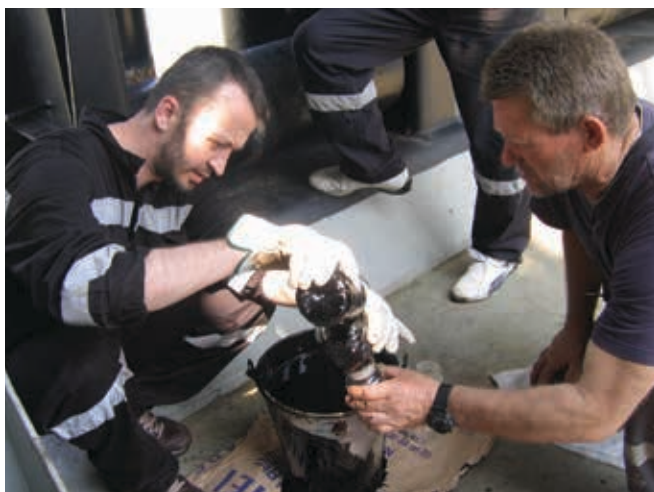
▲ Figura 4: decantación de una muestra de hidrocarburos fuente de combustible a bordo de un buque siniestrado.
