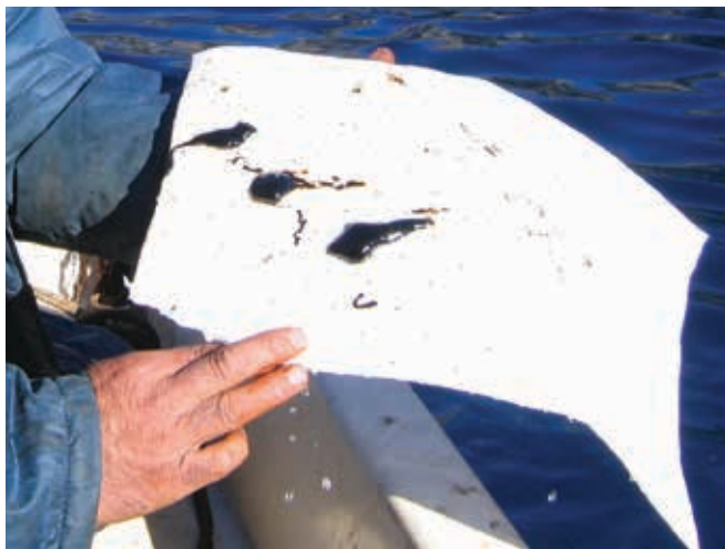
▲ Figura 6: captura de hidrocarburos flotantes con una almohada adsorbente limpia.
