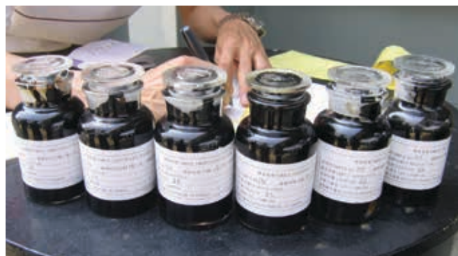
▲ Figura 11: muestras de hidrocarburos bien etiquetadas en frascos de cristal de boca ancha (en este caso muestras divididas de un solo tanque).
