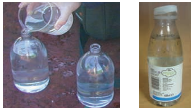
▲ Figura 12: las botellas transparentes de boca estrecha (izquierda) o las botellas de plástico (derecha) no son envases ideales para la monitorización.
