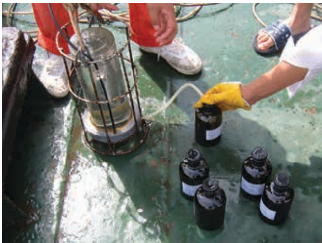
▲ Figura 8: decantación de muestras de agua del dispositivo de recolección de muestras en las botellas de cristal, para obtener muestras divididas.
