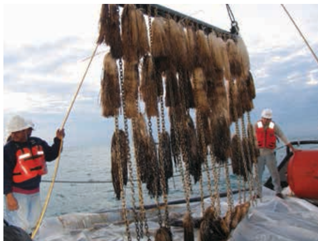
▲ Figura 3: uso de adsorbentes para muestreo submareal. El bastidor, con adsorbente fijado, es remolcado a lo largo del lecho marino. La presencia de hidrocarburos en el adsorbente una vez elevado hasta la embarcación permite conocer el alcance geográfico de los hidrocarburos sumergidos.
