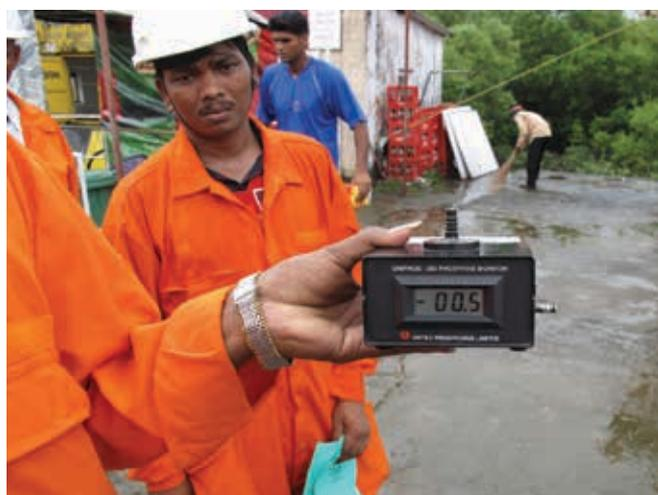
▲ Figura 14: demostración de un monitor portátil de gas fosfínico fuera de un área peligrosa.
