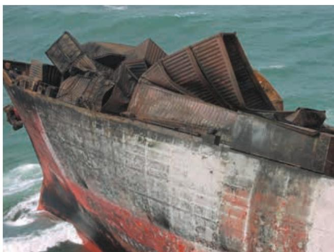
▲ *Figura 9: los contenedores se desplomaron y se deformaron por el calor de un incendio en la sección de proa de un buque Ro-Ro varado.*
