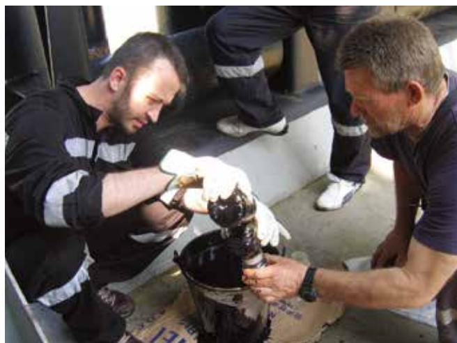
▲ 図4:事故の起きた船上で流出源油であるバンカー燃料の試料を注ぎ移している。
