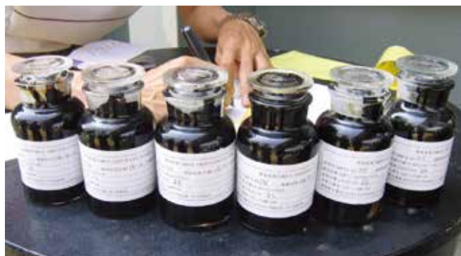
▲ 図11:適切にラベルが貼られているバンカー油試料が口径の広いガラス瓶に入っている(この事例は1つのタンクから採取された分割試料)。
