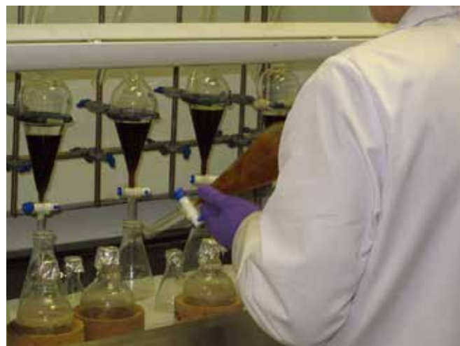
▲ 図13:分液漏斗を用いた油試料の抽出(写真提供:CEFAS)
