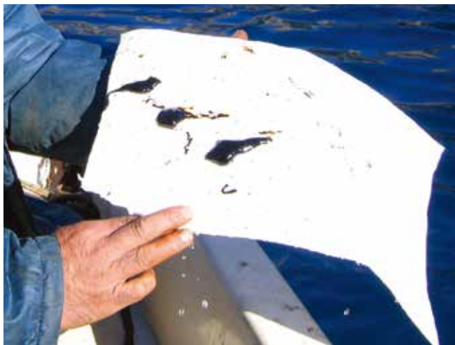
▲ 図6:きれいな吸着材パッドで浮遊油を採取している。
