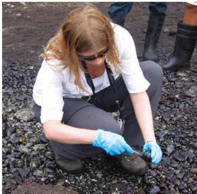
▲ 図7:海岸線に漂着した油のサンプリングをしている。
