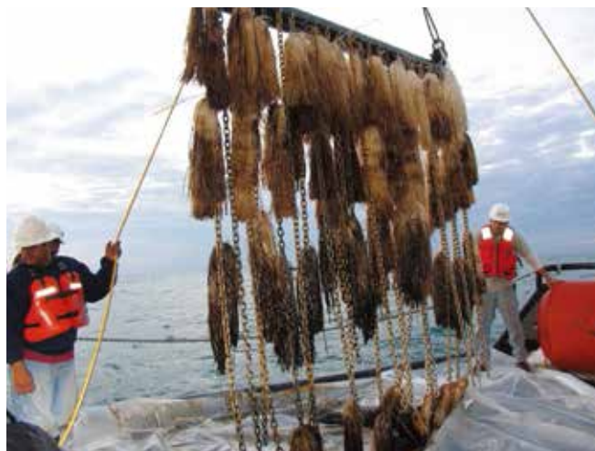
▲ 図3:潮下帯で吸着材を使用しサンプリングをしている。吸着材を取り付けたフレームを海底にはわせてけん引する。引き上げられた時に吸着材に付着した油によって油が沈下した地理的範囲を判断することができる。
