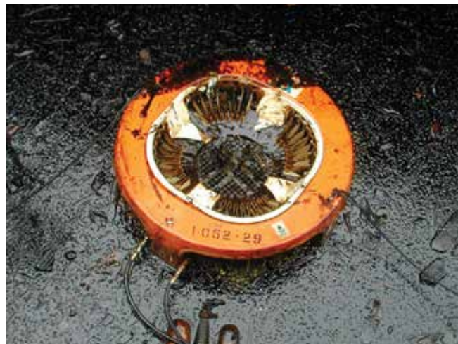
▲ 図15：流出後間もない軽質原油中に投入されて有効に稼働しているディスク式油回収機。しかし、この油が著しく乳化すると、エマルジョンがディスクに付着しないため、回収作業の効果が減少する。
