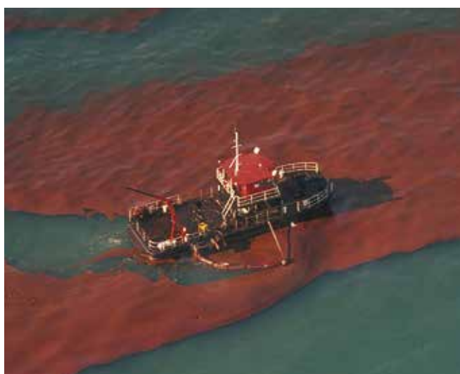
▲ 図10：双胴型の油回収船から展張された長さの短いカーテン型オイルフェンスを使用する単船油回収システム。対象は、乳化の著しい原油。
