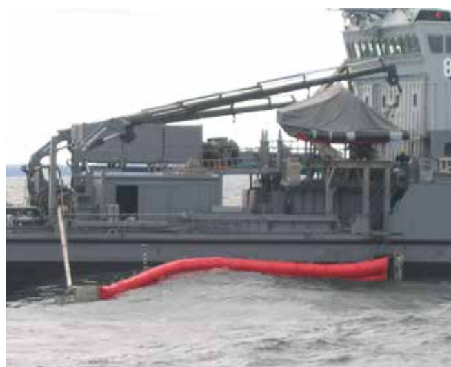
▲ 図11：オイルフェンスは、波の動きに追従できる十分な柔軟性を備えているが、船体取付け部で海面から持ち上がり、先端部から油が漏出する可能性がある。
