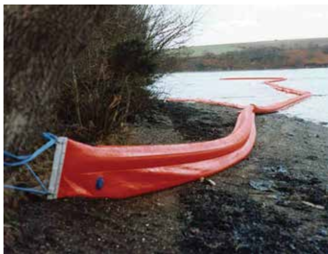
▲ 図18：河口に展張された海岸密着型オイルフェンス。下部の水バラスト室によって、干潮時にオイルフェンスが海岸で安定できる。この例では、海岸密着型オイルフェンスのセクションが充気式カーテン型オイルフェンスのセクションに接続されている。
