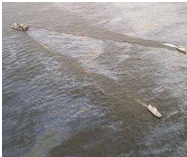
▲ 図9：先端部に別の油回収船を配置して、2隻の曳航船によってV字形に展張されたカーテン型オイルフェンス
