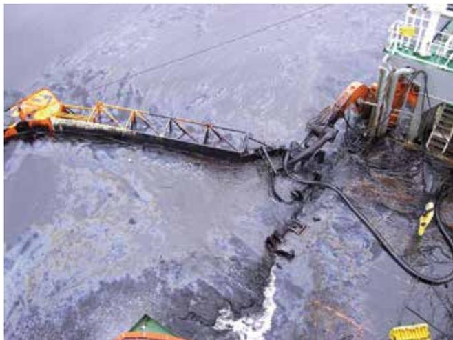
▲ 図33：油圧クレーンを介して回収船に取り付けられた堅固な掃集アーム。フリーボードが低く、大きなうねりに遭遇したため、甲板が乗組員にとって危険な状態になった。
