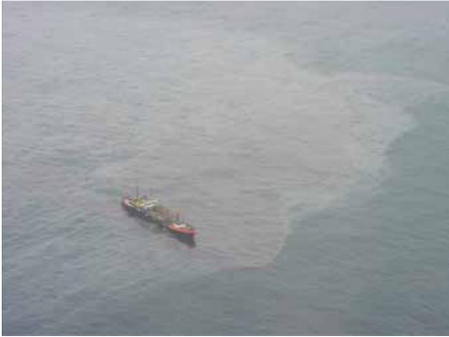
▲ 図18：大きく均質な厚い油膜の中の回収船。対応資源を非常に効果的に使用できる。
