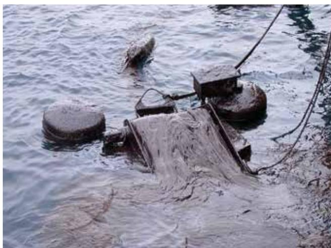
▲ 図16：乳化が進んだ重油中へ投入された堰式油回収機的能力増強のために付加されたベルト・アダプター。油が高粘度であるため、堰へ向かって流れること及び堰の縁を越えることができなかった。代わりに鋸状のベルト・アダプターが油を「掴み」、効率を上げ、更に油の凝集エネルギーによって、残った油が油回収機に向かって「流れる」ようになった。（画像提供：Ro-Clean Desmi及びデンマーク海軍）
