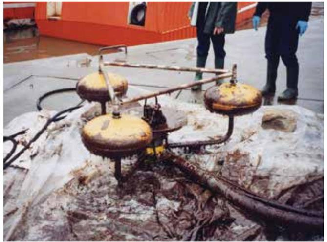
▲ 図37：重質油の回収後に陸揚げされた堰式油回収機。撤収後は次の使用に備えて清掃及び分解点検が必要である。
