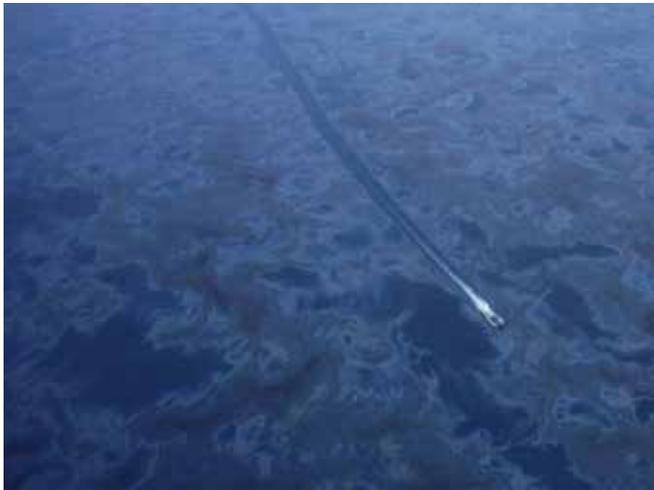
▲ 図19：油が拡散し断片化し始めるにつれ、遭遇率が低下し、回収にはより大きな努力が必要になる。
