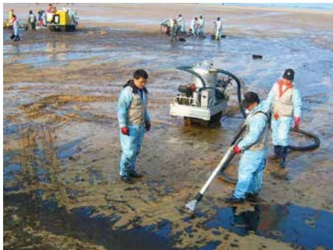
▲ 図9：可搬式真空吸引システムの使用により、砂浜や磯での油回収が容易になる。コンパクトなシステムは貯蔵容量に限られるが、他の方法では近づきにくい場所での作業が可能である。
