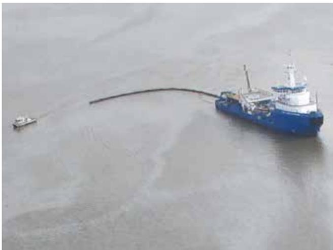
▲ 図29：U字形展張で曳航されるオイルフェンス。主回収船から油回収機が展開されている。
