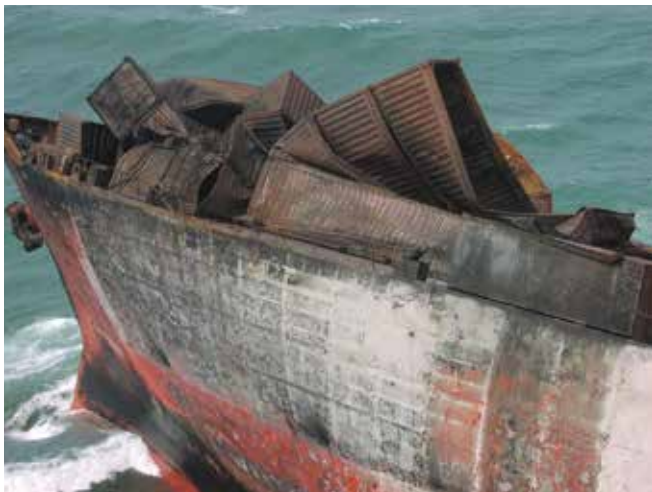
▲ Şekil 9: Sahile vurmuş Ro-Ro gemisinin baş kısmındaki bir yangının ısıyla çöken ve bozulan konteynerler.
