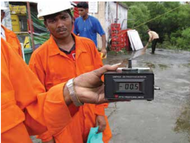
▲ Şekil 14: Tehlikeli bir alanın dışında taşınabilir bir fosfin gazı izlemesinin görüntüsü.
