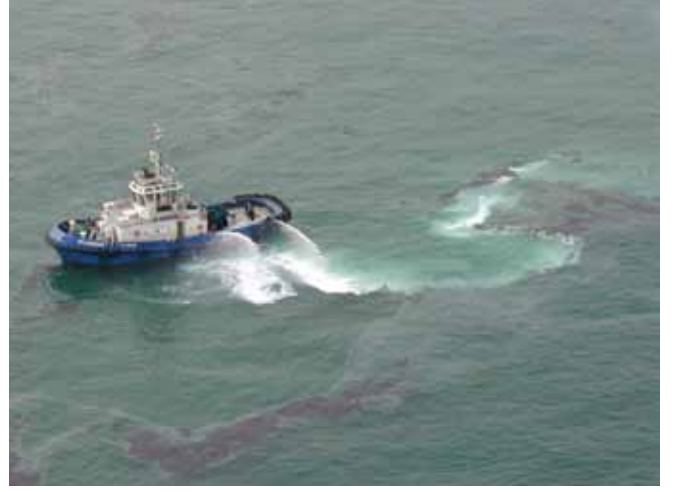
▲ الشكل رقم 14: أدت لزوجة النفط المرتفعة إلى فشل إضافة المشتتات، والتي تظهر من خلال ظهور المسحة البيضاء المعتادة من المادة المشتتة المحيطة بالنفط.
