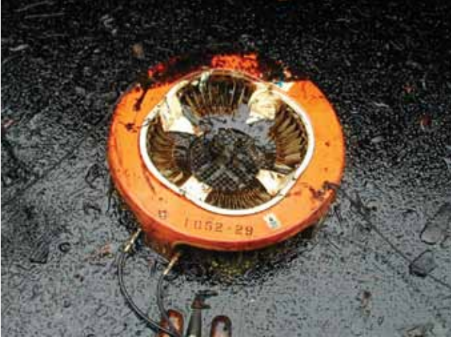
▲ الشكل رقم 15: أداة كشط أسطوانية تعمل بنجاح في انسكاب حديث لنفط خام خفيف. ولكن، إذا قام النفط بتكوين مستحلب بصورة كبيرة، فقد تقل فعالية عملية الاستعادة نظرًا لعدم قدرة المستخدم على الالتصاق بالأسطوانات.
