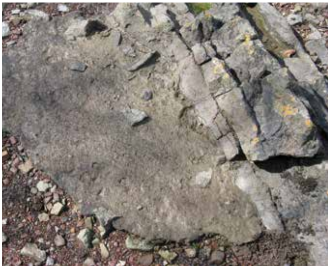
▲ Şekil 10: Bir ham petrol sızıntısını müteakip bir deneyin bir parçası olarak, etkilenen sahil şeridinin bir alanı kasıtlı olarak dokunulmamış bir şekilde bırakılmıştır. Yaklaşık olarak 1m² olan bu petrol parçası asfalt kaplama olarak 15 yıldan daha uzun bir süre kalmaktadır.
