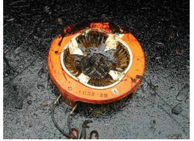
▲ Şekil 15: Kazara yeni dökülmüş hafif ham petrolde başarılı bir şekilde çalışan disk şeklinde süpürücü. Bununla birlikte, petrolün kayda değer bir şekilde sütsüleşmesi halinde, geri toplama çalışmasının verimliliği asıltısının disklere yapışmaması nedeniyle azalabilir.
