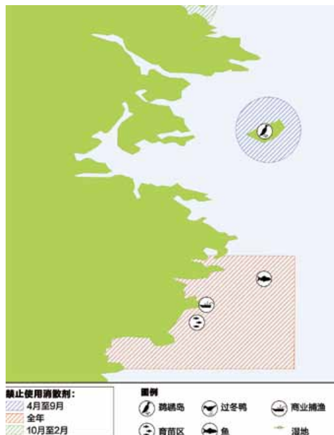
▲ 图 17：在应变计划中常常使用敏感性地图来标示在何处及何时可以使用消散剂。在该示例中，禁止在红色区域使用消散剂，因为这里全年都在进行商业捕鱼；但预先批准了特定季节可以在鹅鹈岛上的鸟类聚居地周围（蓝色）使用消散剂来处理油类。在特殊情况下，可能会允许在大陆附近的浅水域使用消散剂，例如为了保护对搁浅的油类都非常敏感的红树林或沼泽。
