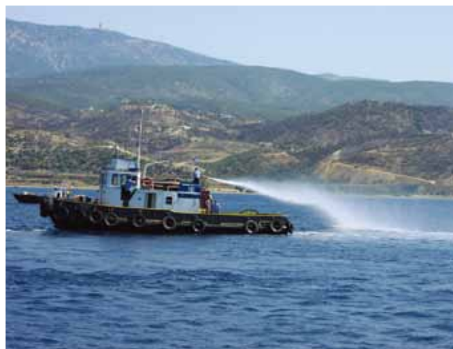
▲ 图 8：使用拖船上的消防炮施用消散剂，该图显示消散剂的扩散不均匀，并受风力影响。
