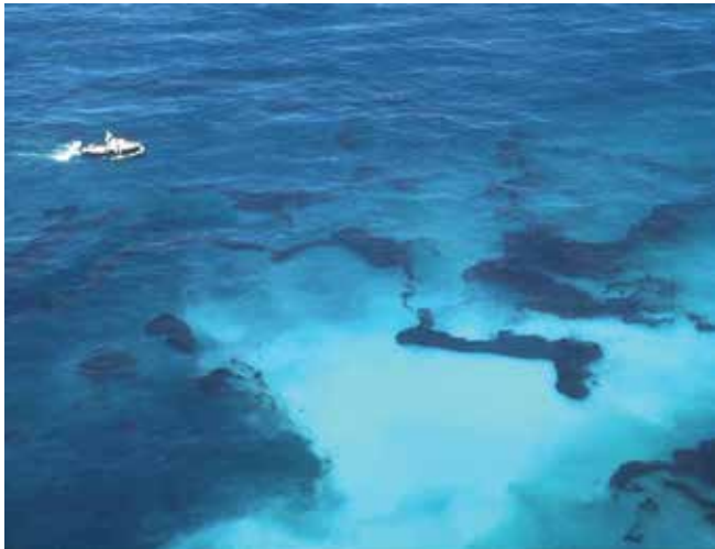
▲ Şekil 5: Dağıtıcı madde ile ağır bir petrolün tabii tutulduğu işlemin etkisizliği suda beyaz bir küme ile kendisini göstermektedir. Petrol etkilenmemiş bir şekilde kalmaktadır.
