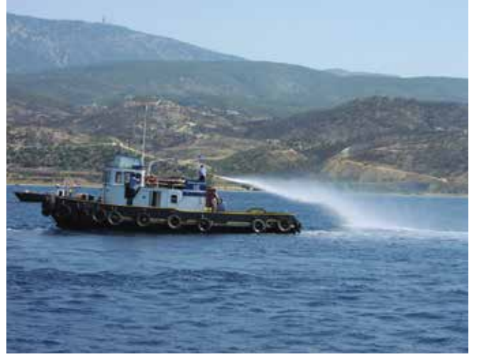
▲ Şekil 8: Bir römorkör üzerinde yangın ekranlarının kullanıldığı dağıtıcı madde uygulaması, dağıtıcı madde düz olmayan yayılımını ve rüzgarın etkisini göstermektedir.
