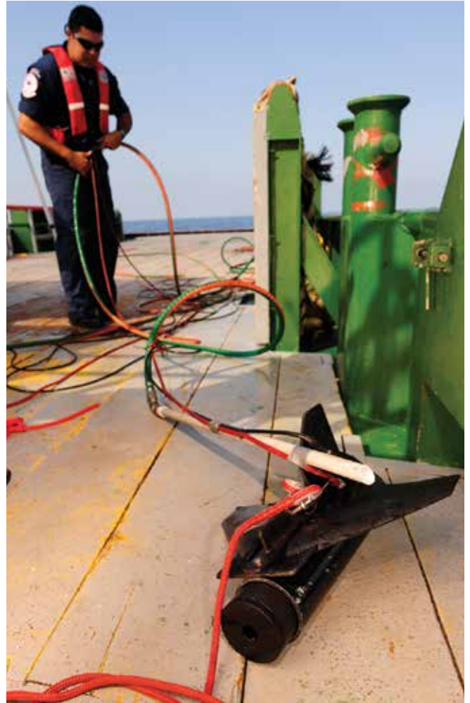
▲ Şekil 13: Denizde dağıtıcı madde verimliliğinin ölçülmesi için yedekte çekilen bir flüoresanlı ölçüm cihazının hazırlanması. (Görüntü USCG'nin izniyle yayınlanmıştır).
