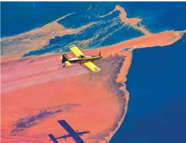
▲ Şekil 9: Kıydan uzak bir platformdan kazara dökülen ham petrol üzerine kanat altı püskürtme kolundan dağıtıcı madde püskürten bir çekici hava aracı. (Görüntü Mark Hamilton Fotoğrafçılık'ın izniyle yayınlanmıştır).
