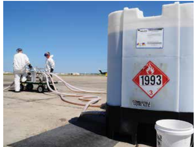
▲ Şekil 12: 1\text{m}^3 Ara Hacim Kaplarının kullanılması dağıtıcı maddenin doğrudan depolanmasına ve yüklenip-boşaltılmasına olanak sağlamaktadır. (Görüntü USCG'nin izniyle yayınlanmıştır).
