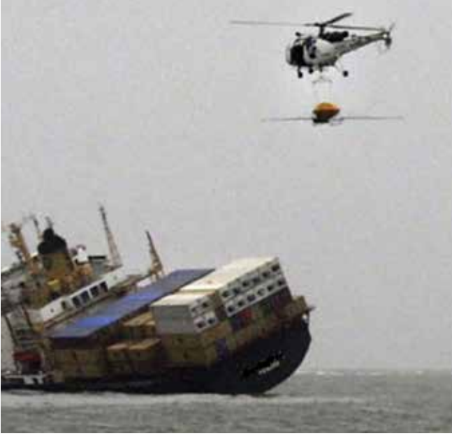
▲ Şekil 11: Altına asılmış bir püskürtme sistemiyle kazara yeni dökülmüş bir yağ yakıtına yaklaşan bir helikopter. Etkili olması için daha alçak bir irtifadan uygulama gerekli olabilmektedir. (Görüntü Hindistan Sahil Güvenliği'nin izniyle yayınlanmıştır).
