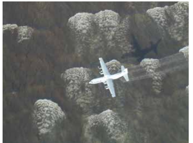
▲ Şekil 10: Çok motorlu bir uçaktan dağıtıcı madde uygulaması. Burada, sığ sularda uygulamanın faydalı olduğu düşünülmüştür.
