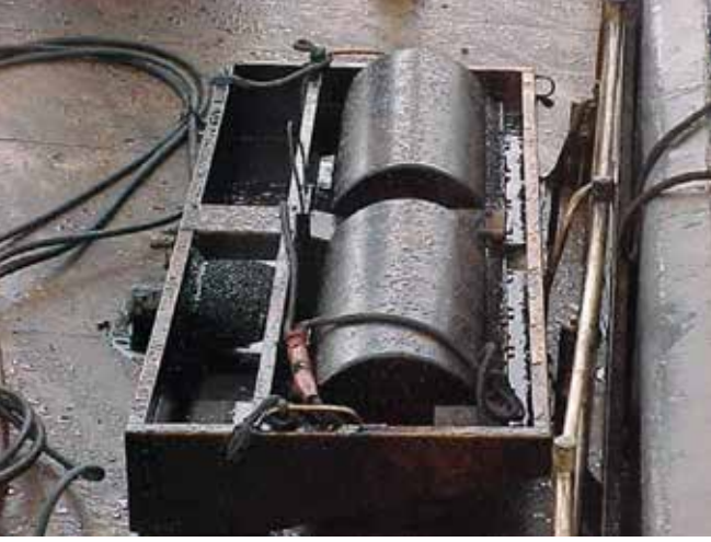
▲ Şekil 4: Yağ çeken varillli deniz süpürücüsü, orta derecede akışmazlığa sahip petroler için uygundur. Petrolün depoya pompalanmak üzere bir boşaltma haznesinin içerisine kazınacak olan dönel varillere yapışması itibarıyla diskli bir deniz süpürücüsüne benzer bir şekilde çalışmaktadır.
