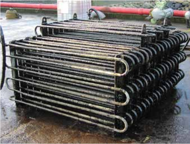
▲ Şekil 27: Akışmaz petrolün toplama gemilerinden kıyıya boşaltılmasına yardım etmek için kullanılan seygar ısıtma bobini.
