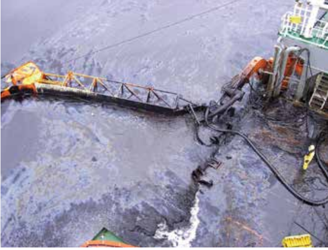
▲ Şekil 33: Sert temizleme kolu bir hidrolik vinç yardımıyla petrol toplama gemisine takılmıştır. Düşük fribord ve denizdeki kabarma gemideki müfredat açısından güvertedeki koşulları oldukça tehlikeli bir hale getirmiştir.
