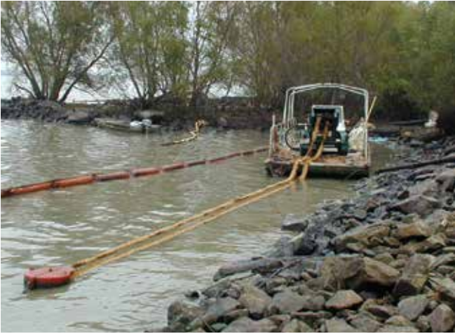
▲ ▶ Şekil 6 ve Şekil 7: Yatay ve düşey yağ çeken halatlı deniz süpürücüler. İç içe geçmiş emici ilmikler petrolün yapıştığı yüzey üzerinde dalgalanan kesintisiz bir paspas meydana getirmektedir. Paspas, bir silindire doğru geri itilmektedir ve petrol bir depolama tankına sıkılmaktadır. Halat paspaslı deniz süpürücüler petrolün döküntü, buz ve diğer engellerden toplanması için faydalı olmaktadır.
