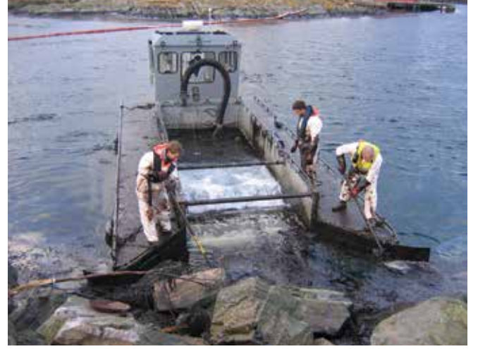
▲ Şekil 34: Korunaklı bir kayalık girişinde petrol toplayan kendinden tahrikli bentli deniz süpürücüsü. Geminin sığ su derinliği kıyıya yakın çalışmaya olanak sağlamaktadır. Operatörler petrolü bendin ağzına doğru hareket ettirerek yardımcı olmaktadır.
