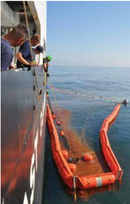
▲ Şekil 29: Ana toplama gemisinden plana göre yerleştirilen bir deniz süpürücüsüyle "U" biçiminde bir yapısal düzenlemede yedekte çekilen engel.
