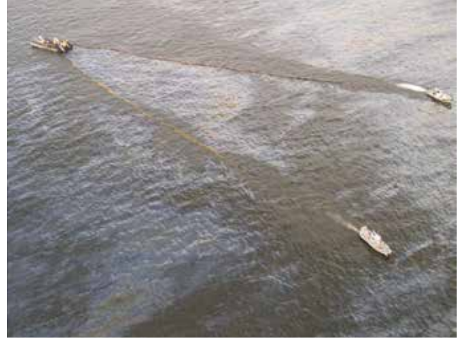
▲ Şekil 30: "V" biçiminde bir yapısal düzenlemede yedekte çekme gemileri ve engelle yayılan kayışlı bir süpürme gemisi.
