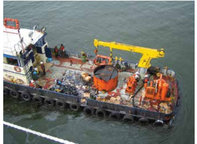
▲ Şekil 24: Güvertede sınırlı miktarda toplanan petrolün depolanmasına yarayan deposu olan bir iş teknesi.
