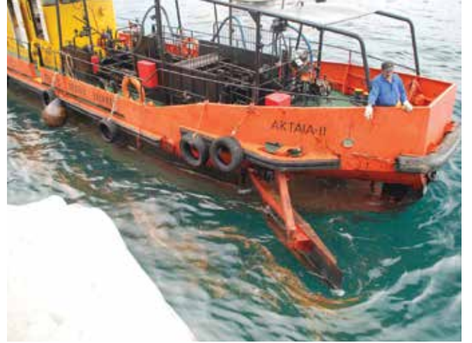
▲ Şekil 1: Limanlarda ve sahile yakın sularda kullanmak için kendinden tahrikli bir bent süpürücüsü. Pruva kapıları şeridin genişletilmesi ve su yüzeyinde yüzen petrol tabakasının girişine olanak sağlanması için açılmaktadır. Toplanan petrol bir iç depolama tankına pompalanmaktadır.
