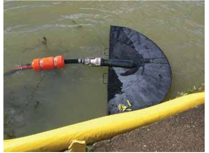
▲ Şekil 11: Bir vakum pompasına tutturulmuş sabit bentli deniz süpürücüsü Başlığın kenarındaki birtakım küçük giriş delikleri petrolün seçmeli olarak toplanmasına olanak sağlamaktadır. Sakin sularda en az seviyede döküntüyle kullanılmak için (Görüntü Lamor'un izniyle yayınlanmıştır).
