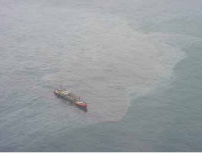
▲ Şekil 18: Su yüzeyinde büyük, kalın ve homojen bir petrol tabakasında kaynakların çok etkili bir şekilde kullanılmasına olanak sağlayan bir toplama gemisi.
