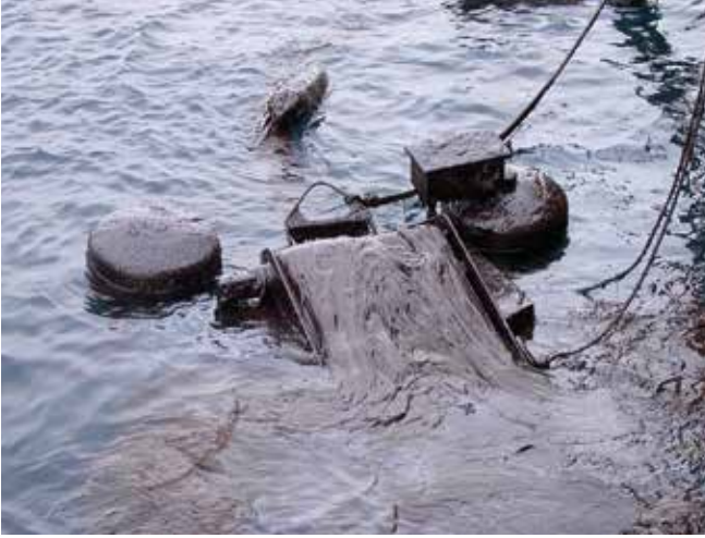
▲ Şekil 16: Yüksek derecede sütsüleşmiş yağ yakıt durumunda altta bendi olan deniz süpürücüsünün kapasitesinin artırılması için ilave edilen kayışlı bağdaştırıcı. Petrolün yüksek akışmazlığı bendin kenarına doğru ve üstünden akmasını engellemiştir. Bunun yerine, dişli kayışlı bağdaştırıcı petrolü "tutmuş", verimliliği artırmıştır, petrolün birleşme enerjisi geriye kalan petrolün deniz süpürücüsüne doğru "akmasına" neden olmuştur (Görüntü Ro-Clean Desmi/ Danimarka Deniz Kuvvetleri'nin izniyle yayınlanmıştır).
