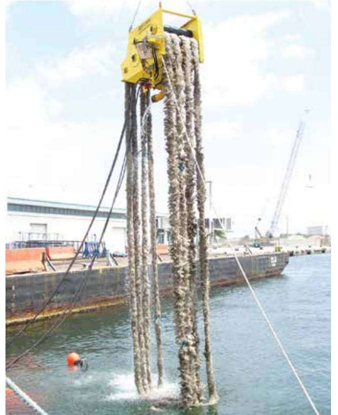
▲ Şekil 5: Serbest yüzen fırçalı deniz süpürücüsü. Petrol, dönel fırça takımlarına yapışmaktadır ve su yüzeyinden kaldırılmaktadır. Bir tarak, petrolü depolamak için fırçalardan toplamaktadır. Fırçanın arkasındaki bir pervane, karşılama oranını ve verimliliği artırmak için su yüzeyinde yüzen petrolü deniz süpürücüsüne doğru çekmektedir (Görüntü Lamor'un izniyle yayınlanmıştır).
