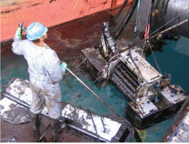
▲ Şekil 17: Bir liman alanına plana göre yerleştirilen bir mekanik varilli deniz süpürücüsü. Dönel varil üzerindeki dış petrolü varilin içerisine toplandığı ve depolanmak üzere pompalandığı cihaza doğru çekmektedir. Varil, su toplanmasını en aza indirmek için bir ağdan yapılmaktadır.
