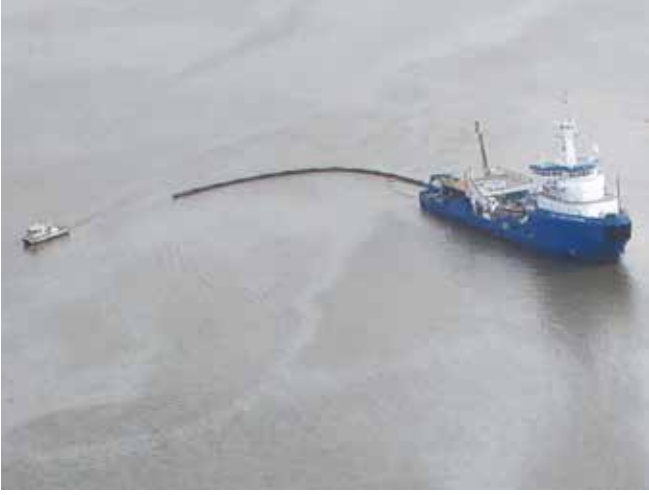
▲ Şekil 29: Ana toplama gemisinden plana göre yerleştirilen bir deniz süpürücüsüyle "U" biçiminde bir yapısal düzenlemede yedekte çekilen engel.
