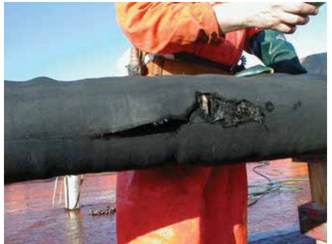
▲ Şekil 23: Yüksek derecede akışmaz olan petrolün pompalanmasından kaynaklı aşırı iç basıncın bir sonucu olarak patlayan hortum (Görüntü NOFO'nun izniyle yayınlanmıştır).
