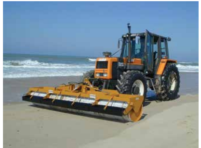
▲ Şekil 36: Traktöre takılan yağ çeken varilli deniz süpürücüsü, sertleşmiş bir kum sahilde taze katran topraklarının toplanması için kullanılmaktadır (Görüntü Le Floch Depollution'un izniyle yayınlanmıştır).
