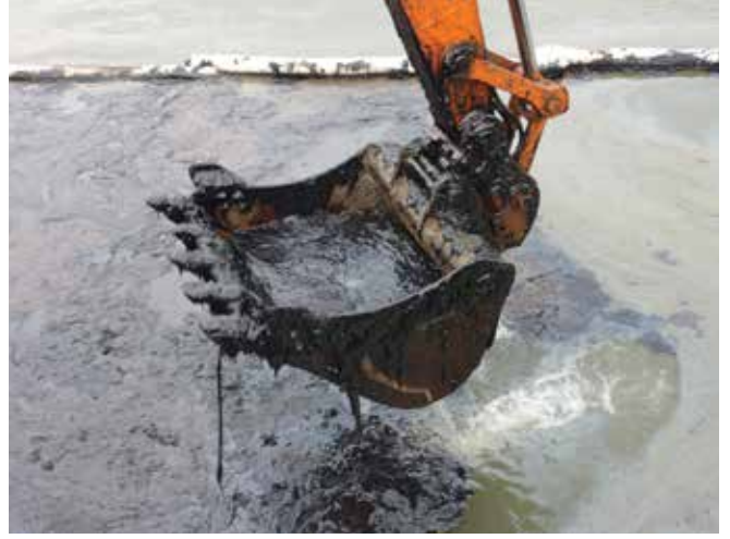
▲ Şekil 21: Son derece akışmaz yağ yakıtın toplanması için bir kazıcının kullanılması. Toplanan petrolün yoğunluğu operatöre sürüklenen suyun akmasına olanak sağlamak için keçeyi su yüzeyi üzerinde kısa bir süre boyunca tutması talimatı verilerek azami seviyeye çıkartılmıştır. Bu, toplama verimliliği pahasına sonradan bertaraf maliyetlerini azaltmıştır.
