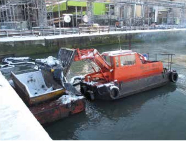
▲ Şekil 35: Genellikle limandaki molozu toplamak için kullanılan kendinden tahrikli deniz aracı. Burada, düşük sıcaklık ve petrolün nispeten yüksek akma noktası, petrolün yarı katı hale gelmesine ve bunun sonucunda da kepçe ile toplanarak yüzer çöp konteynırına konmasını gerekli kılmıştır.
