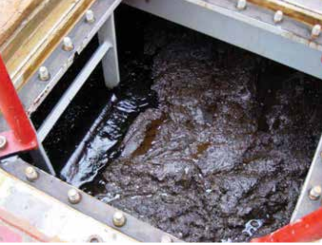
▲ Şekil 25: Bir toplama gemisinin üzerinde bir depolama tankında toplanan çok akışmaz petrol.
