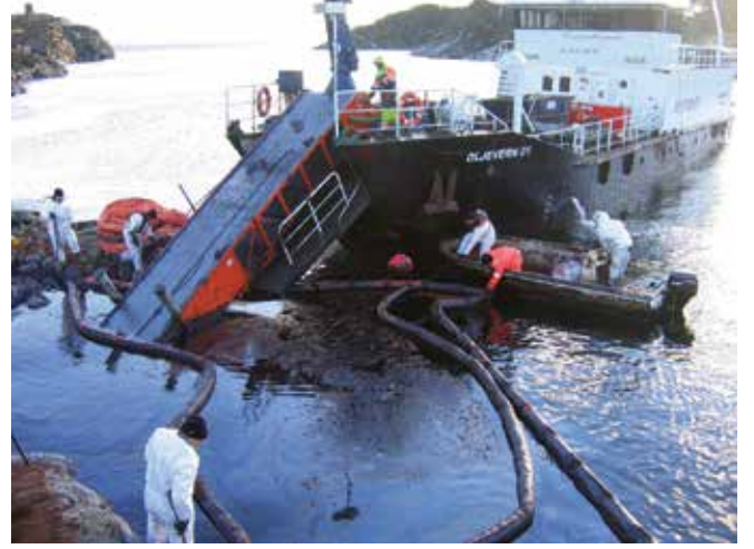
▲ Şekil 15: Geniş bir toplama gemisinin üzerindeki bir kayışlı deniz süpürücüsü. Bir ağdan yapılmış olan kayış suyun baştan sona kadar boşalmasına olanak sağlamaktadır ve petrolün yapışmasını teşvik etmektedir. Petrol güverteye kaldırılmaktadır ve depolanmak üzere kazanılmaktadır.
