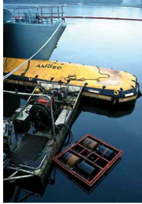
▲ Şekil 26: Petrolü havayla şişirilebilir bir depolama mavnasına toplayan varilli bir deniz süpürücüsü.
