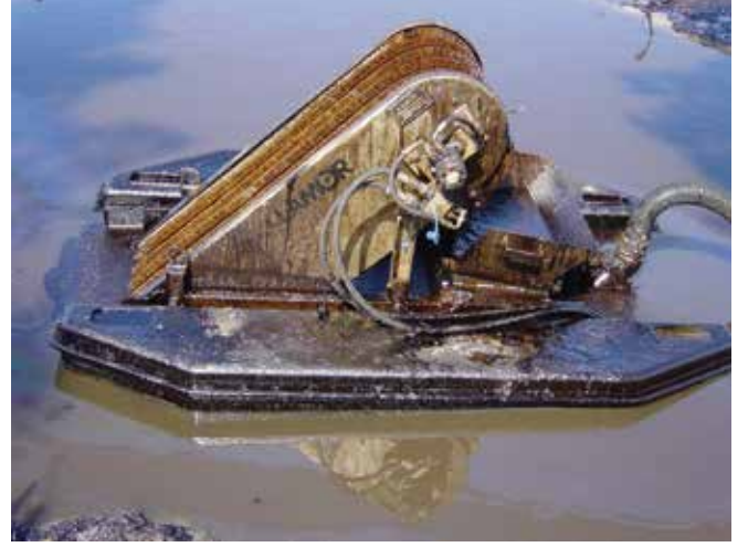
▲ Şekil 5: Serbest yüzen fırçalı deniz süpürücüsü. Petrol, dönel fırça takımlarına yapışmaktadır ve su yüzeyinden kaldırılmaktadır. Bir tarak, petrolü depolamak için fırçalardan toplamaktadır. Fırçanın arkasındaki bir pervane, karşılama oranını ve verimliliği artırmak için su yüzeyinde yüzen petrolü deniz süpürücüsüne doğru çekmektedir (Görüntü Lamor'un izniyle yayınlanmıştır).
