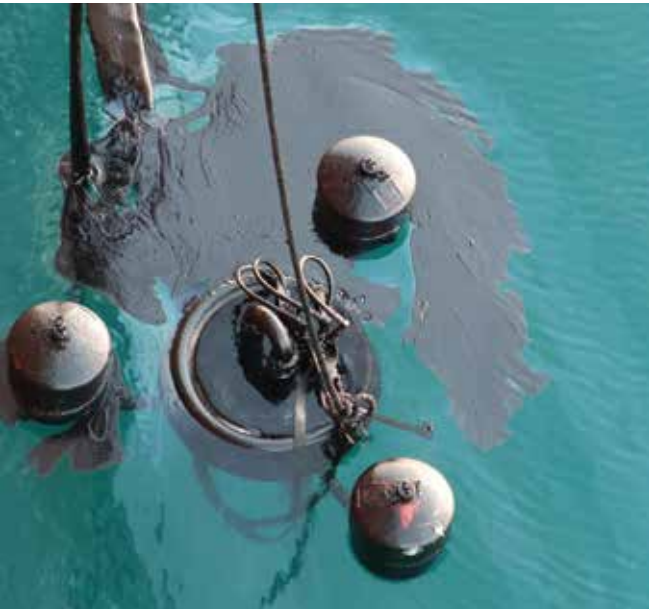
▲ Şekil 10: İşçiler doğrudan petrolün içerisindeki bir vakum pompasına takılan bir hortumu yerleştirirken. Bu örnekte, küçük bent eklentisi sürüklenen suda sonuç olarak olası artış ile birlikte akışmaz yağ yakıtın hortumun içerisine akmasına olanak sağlamak için kaldırılmıştır.
