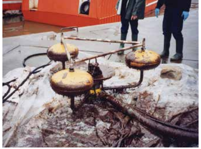
▲ Şekil 37: Ağır petrolün toplanmasından sonra kıyıya getirilen bentli bir deniz süpürücüsü. Geri taşınmayı müteakip donanımların temizlenmesi ve gelecekte kullanıma hazır olmak üzere elden geçirilmesi gerekmektedir.
