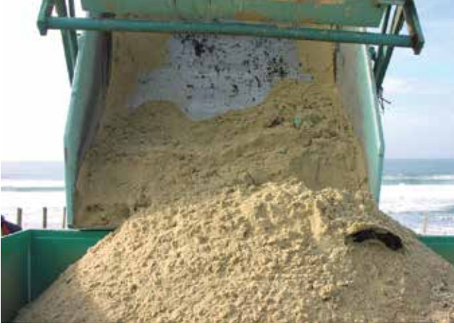
▲ Şekil 7: Ağır makinelerle doğrudan toplama işlemi yüksek bir temiz malzeme oranı ve atıkta çok düşük petrol yoğunlukları ile sonuçlanmıştır.
