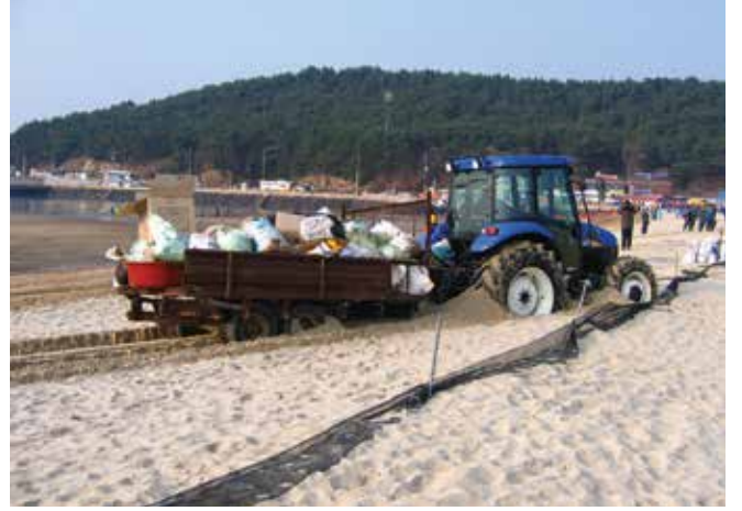
▲ Şekil 39: Yüklü taşıtlar yumuşak alt katmanların içine bataabilmektedir. Bu ek hasara yol açabilmektedir ve petrol başka bir şekilde temiz tortuyla karışabilmektedir.
