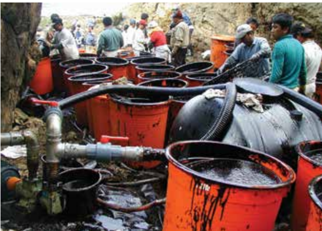
▲ Şekil 13: Kayalık bir sahil şeridinde toplanan geniş üstü açık kaplar içerisinde depolanan petrol. Pompaların bu petrolü sarp kayalığın en üstüne ve daha sonra karayolu tankerlerine aktarması gerekmektedir.
