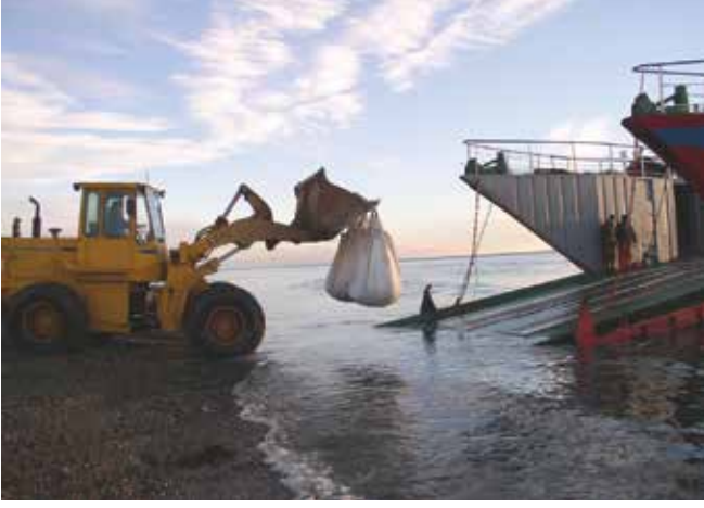
▲ Şekil 11: Bir tonluk "büyük çuvallar" içerisinde birleştirilen petrol bulaşmış olan daha küçük torbalar yalıtılmış bir sahil şeridinden kaldırılmak üzere bir çıkarma gemisi üzerinde taşınmaktadır.
