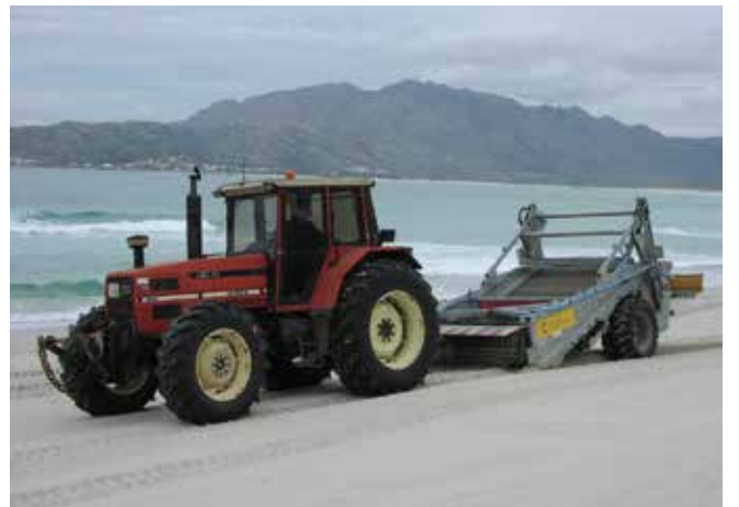
▲ Şekil 26: Katran toplarını toplayan, bir traktörle çekilen kumsal temizleme makinesi.
