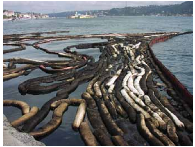
الشكل رقم 7: حاجز تطويق طافٍ ماص ملوث جزئيًا بالنفط. يجب تجنب استخدام المواد الماصة على نطاق واسع للحد من توليد النفايات.
