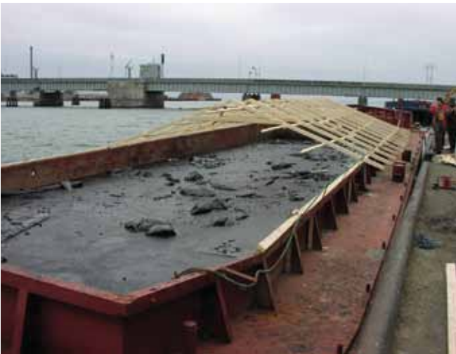
الشكل رقم 10: النفط المستعاد مخزن على صندل بحري. يجب استخدام غطاء للحيلولة دون دخول مياه المطر.
