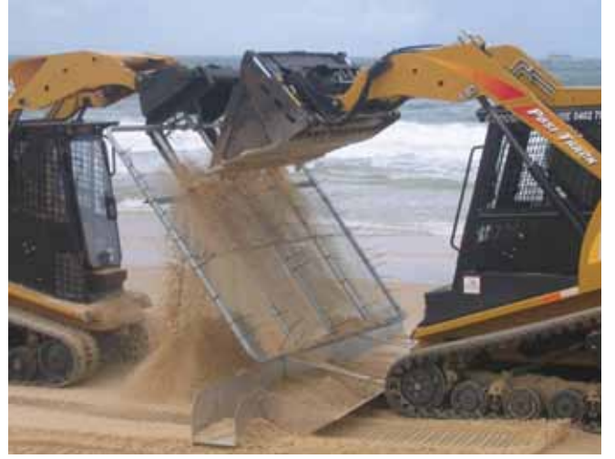
▲ الشكل رقم 17: الغرلة الميكانيكية لكتل القطران من الرمال لتقليل كمية النفايات المتولدة.
