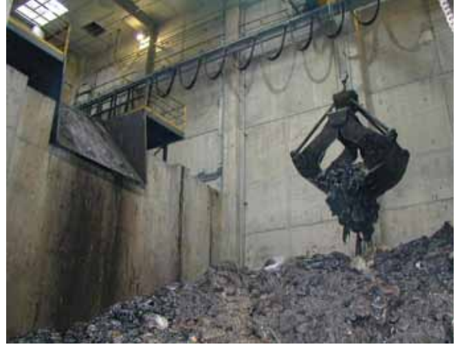
▲ الشكل رقم 19: أكياس من النفايات الملوثة بالنفط يتم إدخالها إلى منحدر تحميل جهاز حرق صناعي كبير للتخلص منها جنباً إلى جنب مع النفايات المنزلية.
