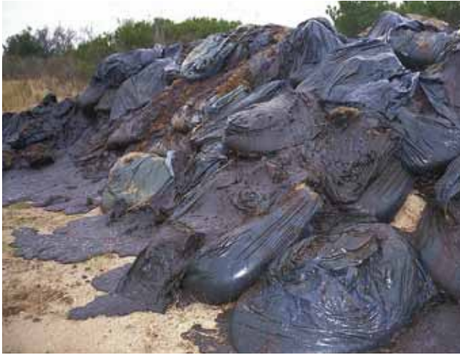
▲ الشكل رقم 12: يمكن أن يؤدي تحلل الأكياس البلاستيكية بسبب التعرض لضوء الشمس لفترات طويلة إلى إعادة التلوث.
