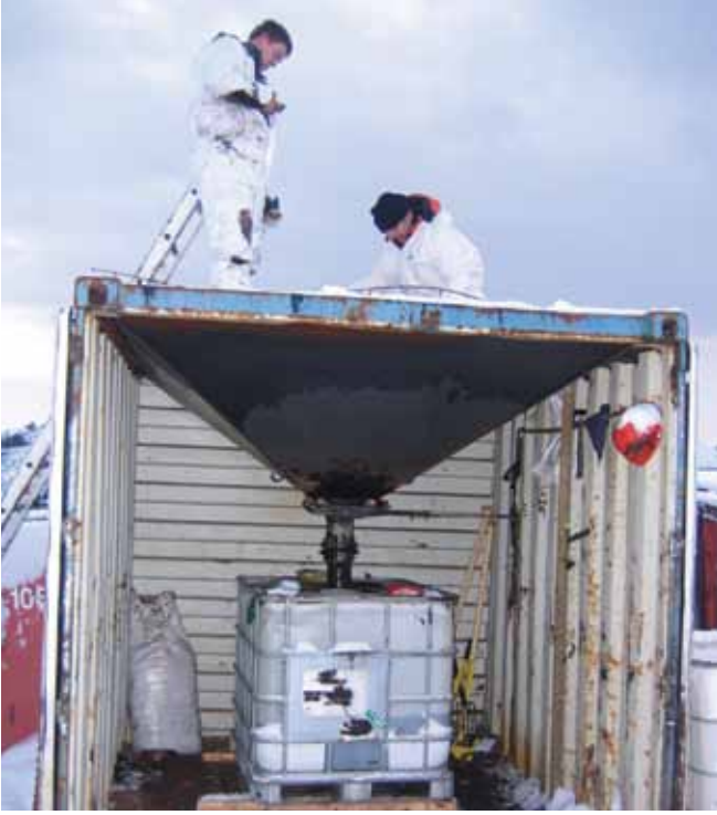
▲ الشكل رقم 16: نظام مرتجل لترشيح النفايات، حيث يتم تمرير النفط المستعاد من خلال قمع شبكي لترشيح حطام السفن.
